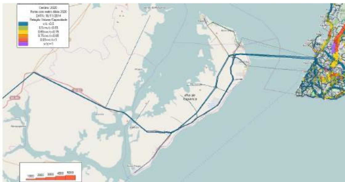
Figura 38 – Carregamento com o Nível de Serviço das vias na Ilha de Itaparica em 2020 , com a possível implantação do SVO (BAHIA, 2014b).
